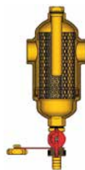
Esquema montaje accesorio: Desfangador + Sep. Magnético
